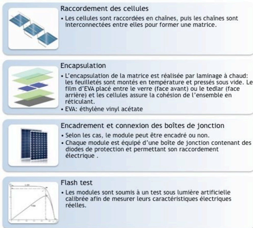
Figure 11 : Assemblage des modules photovoltaïques
