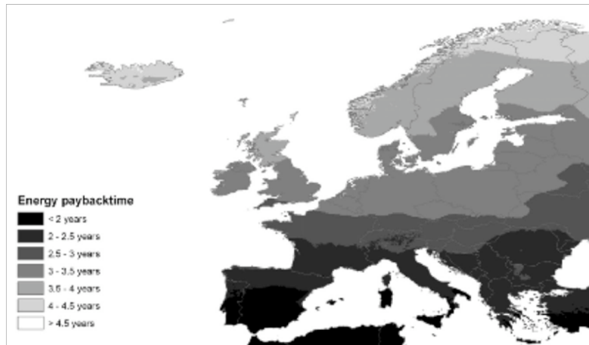
Figure 14 : Temps de retour énergétique de systèmes PV à 90% de silicium cristallin en Europe [18]
